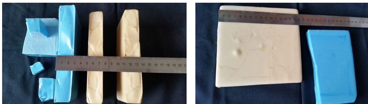
Obr. 16 Placky mozaikového skla připravené přetavením mačkárenských tyčí. Foto Jiří Blaho
