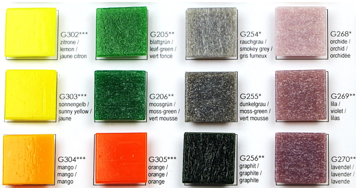
Detail vzorníku italské lité mozaiky – Murano glass, žlutá, oranžová a červená – hladká litá mozaika, ostatní odstíny jsou patří pod označení pískovaná litá mozaika. Foto I. Kučerová
