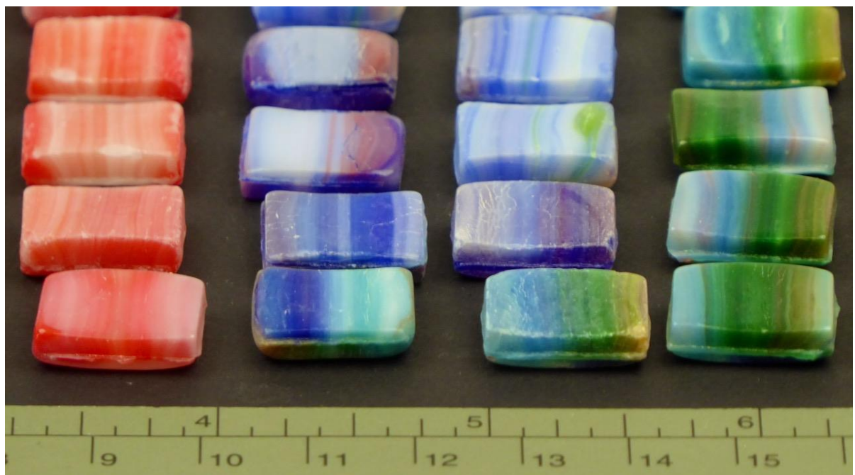
Repliky rotačně mačkané mozaiky – detail. Foto I. Kučerová
