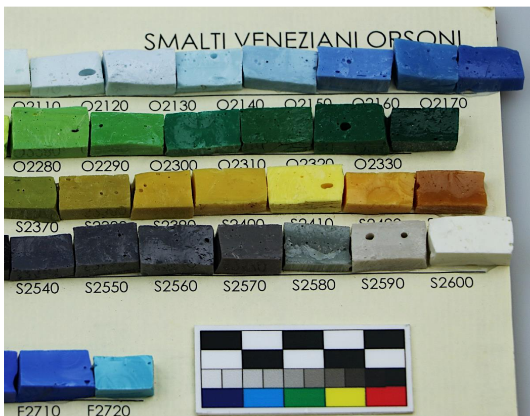
Detail vzorníku italského prodejce štípaného mozaikového skla. Pohledová strana kostek má rozměr přibližně 10 x 15 mm, tloušťka je cca 5-10 mm. Foto I. Kučerová.
